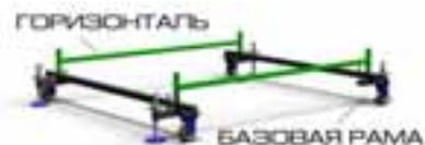
1. Установите параллельно две базовые рамы; вставьте между ними горизонталы
