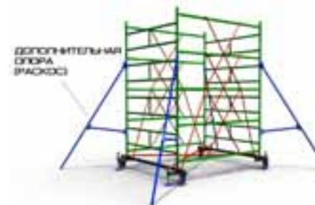
5. В такой последовательности (установка нижних горизонталей, установка боковин, установка верхних горизонталей и затем скрещивающихся стяжек) продолжайте монтаж помоста (туры). Если высота помоста превышает 4м, установите 4 дополнительные опоры.
